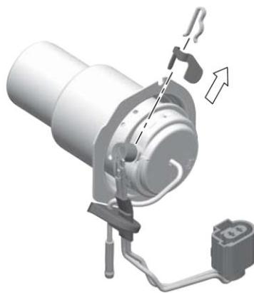
Рис. 9-7 Удалите охлаждающее ребро
