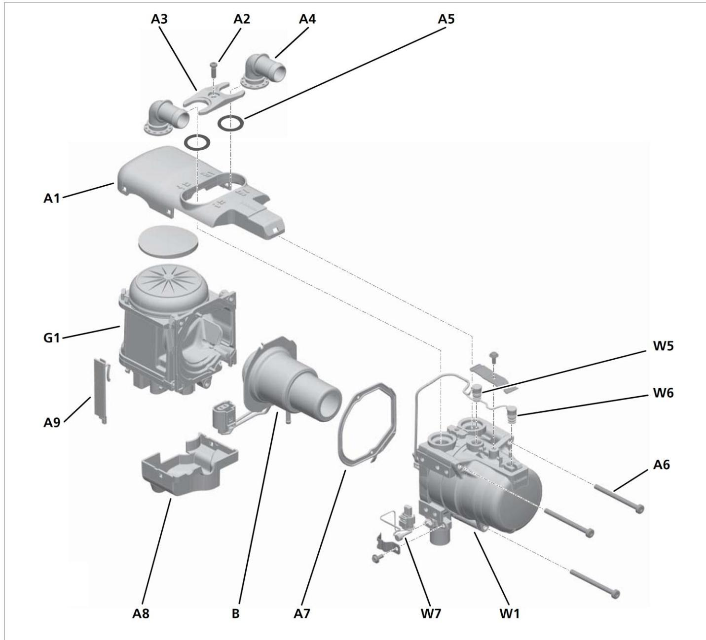
Рис. 9-1 Компоненты подогревателя Thermo Pro 50 Eco
