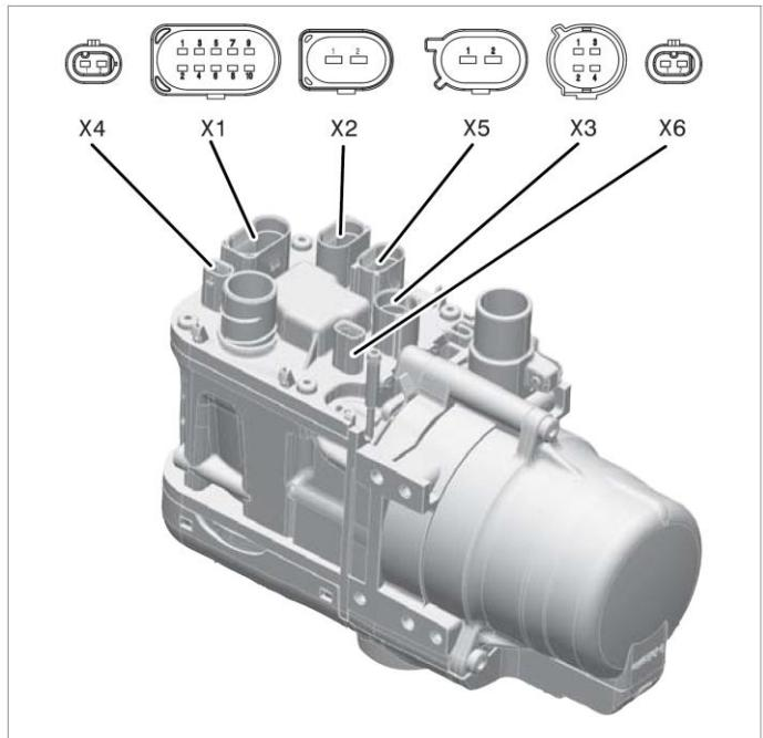
Рис. 9-16 Нагнетатель с расположением электрических разъемов (представленный вариант с максимальной раскладкой разъемов)
