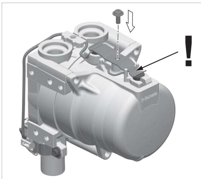
Рис. 9-20 Установка винта
