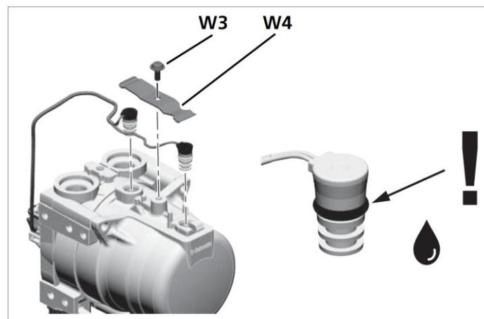
**Рис. 9-18 Смазка уплотнений**
