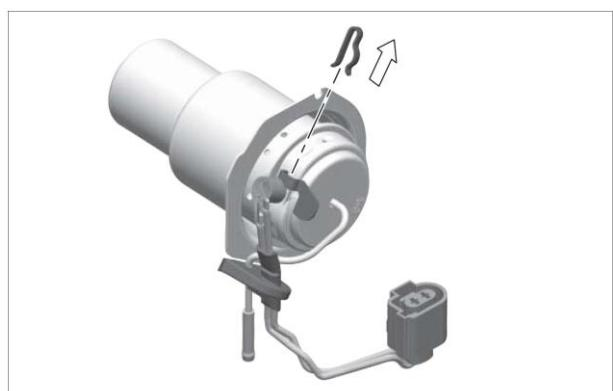
Рис. 9-6 Удалите пружинный держатель
