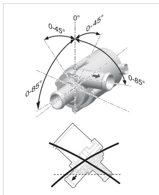
**Рис. 8-1 Установочные положения циркуляционного насоса U4847 Econ 24B**
