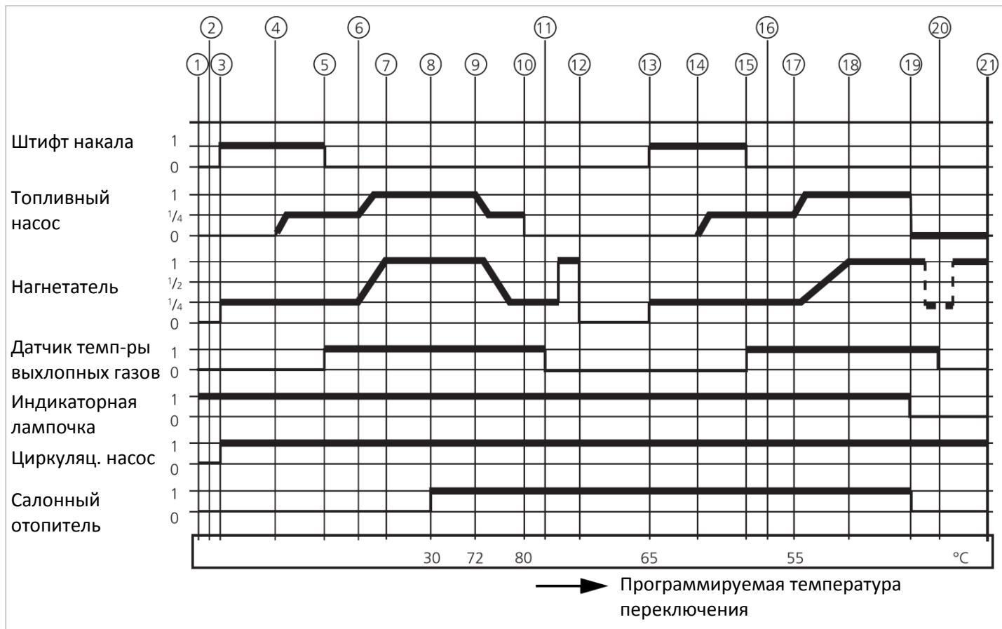
Рис. 3-1 Диаграмма функционирования Thermo Pro 50 Eco
