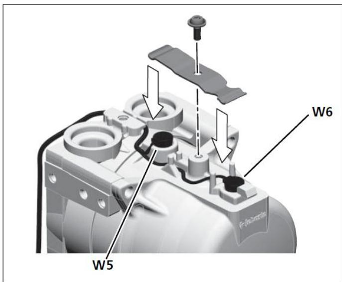
Рис. 9-19 Установка пружинного фиксатора, обращайте внимание на расположение кабельного жгута и положение датчиков W5 и W6
