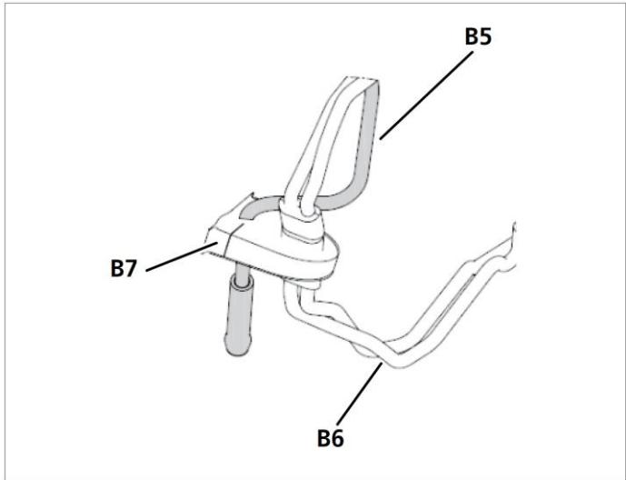
Рис. 9-15 Кабель штифта накала, уплотнение и топливная трубка
