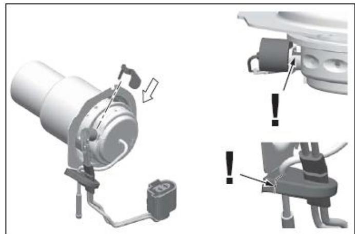
Рис. 9-10 Установка охлаждающего ребра
