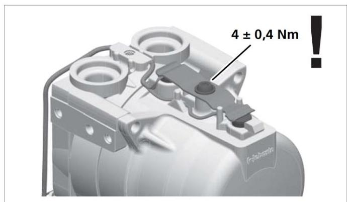
Рис. 9-21 Затяжка винта
